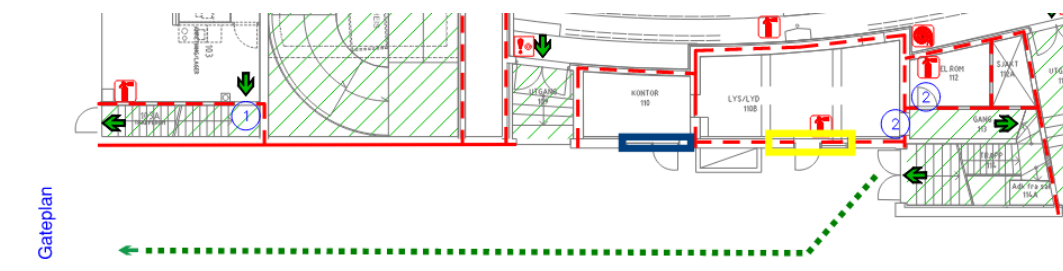
Figur 7: (tilsvarende som figur 2 vist innledningsvis) utsnitt fra branntegningen som viser det aktuelle vindusfeltet som sitter nærme utgangen markert med gult og vindusfeltet det rømmes forbi i «Kontor 110» markert med blått.
