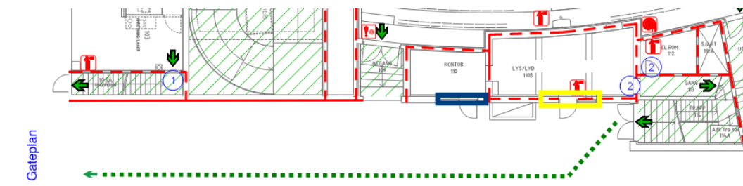
Figur 2: utsnitt fra branntegningen som viser det aktuelle vindusfeltet som sitter nærme utgangen markert med gult og vindusfeltet det rømmes forbi i «Kontor 110» markert med blått.
